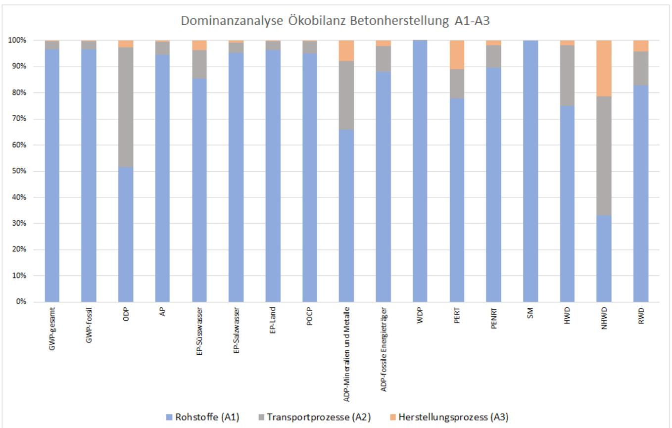
**Figure 4 Analyse de dominance de la fabrication (A1-A3)**
